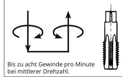
Bis zu acht Gewinde pro Minute bei mittlerer Drehzahl.
