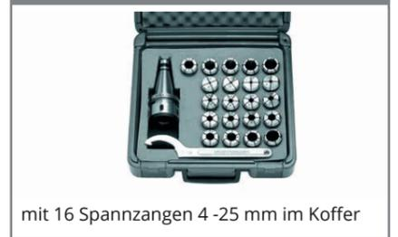
mit 16 Spannzangen 4 - 25 mm im Koffer
