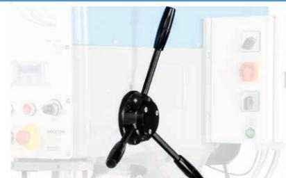
Die Vorschübe werden besonders einfach durch leichtes seitliches Drücken eines der Vorschubhebel ein- sowie ausgeschaltet. Bei Maschinen mit Gewindeschneideeinrichtung wird beim Gewindeschneiden die Drehrichtung durch drücken des Vorschubhebels geändert.
